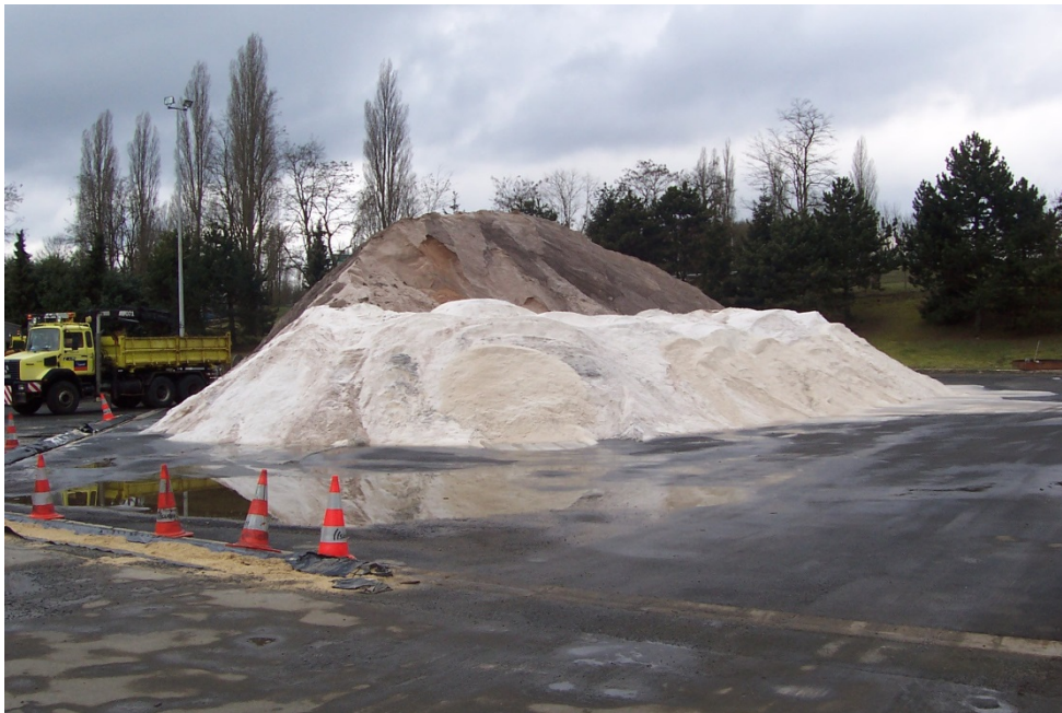
Stockage de chlorure de sodium à l'air libre avec des conséquences directes sur l'environnement.
